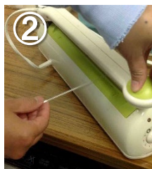
② ストロー管の先端をシーリング。
