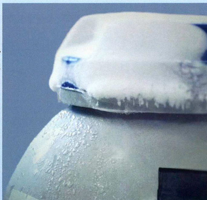
真空漏れを起こしたタンク表面（温度低下により結露した状態）
